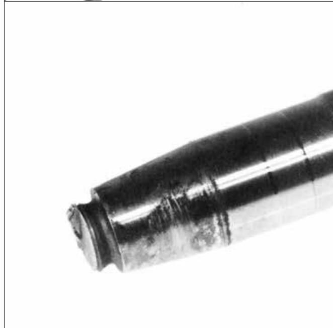
Oxidação por fricção e ruptura do eixo de acionamento, produzida respectivamente pelo atrito e pela luva de acoplamento mal colocada.
