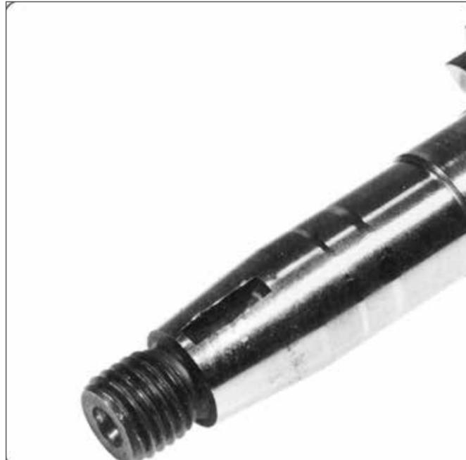
Rebarbas no rasgo de chaveta, produzidas pela luva de acoplamento mal posicionada.
